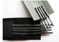
Angespitzte Mikrokontakte an textile Leier für Mini-USB-Stecker
