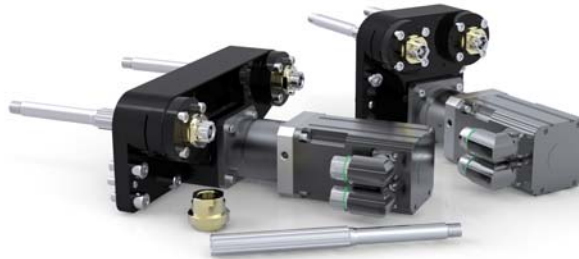
Als Messeneuheit präsentiert i-mold aus seinem Eigenprogramm „Servomold“ die kompakte, servoelektrisch angetriebene und deswegen reinraumtaugliche Servo-Ausschraubeinheit „Doppel“ zum vollautomatischen Entformen von Innengewinden beim Spritzgießen.
